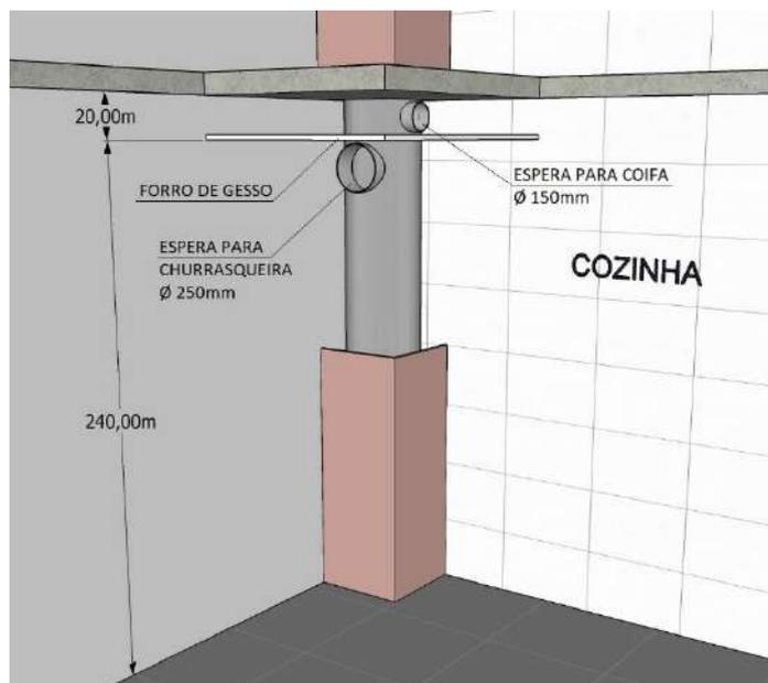
Todos os equipamentos (churrasqueira, fornos, fogão, etc) devem ser instalados por profissionais capacitados e especializados no sistema, conectados ao duto com a devida vedação, instalados com “registro de fumaça” (ver figura) que, quando o equipamento não estiver em uso deve ficar fechado para não haver retorno de fumaça.
